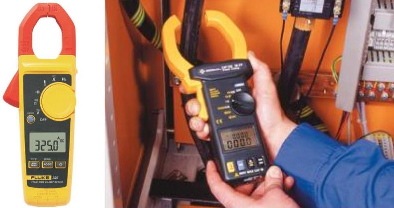
On dispose un circuit constitué d'un enroulement torique de N spires carré de côté a autour du fil (voir figure ci-dessous, ce circuit correspond au circuit interne de la pince). Ce bobinage est fermé sur un ampèremètre, le circuit ainsi réalisé a une résistance totale R et est parcouru par induction par un courant  $i(t) = i_m \cos(\omega t + \varphi)$  qui crée un champ magnétique  $\vec{B}_{Tore}(M) = \frac{\mu_0 N i}{2\pi r} \vec{e}_\theta$  à l'intérieur du tore.
