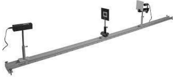
Pour chaque fente de largeur  $e$ , relever la largeur  $L$  de la tache centrale. Compléter le tableau ci-dessous.
